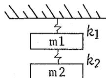
$$\begin{bmatrix} -m_1 \omega^2 & 0 \\ 0 & -m_2 \omega^2 \end{bmatrix} \begin{Bmatrix} X_1 \\ X_2 \end{Bmatrix} + \begin{bmatrix} k_1 + k_2 & -k_2 \\ -k_2 & k_2 \end{bmatrix} \begin{Bmatrix} X_1 \\ X_2 \end{Bmatrix} = 0 \quad (24)$$
