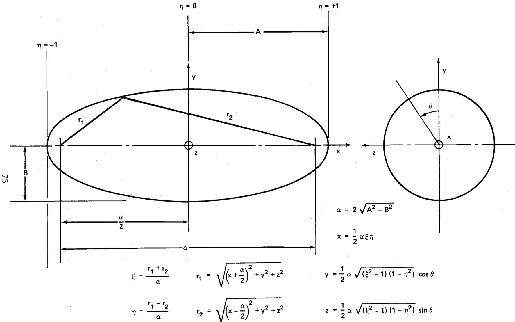
FIGURE 1 - PROLATE SPHEROIDAL COORDINATE SYSTEM
